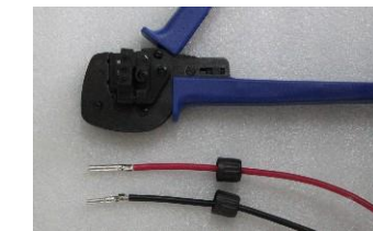
▲ Figuur 4.8 Krimp de contactpen op de draad
